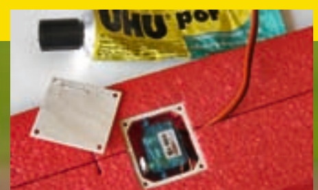
♥ Die stelligenauen und zuverlässigen Digi 5G von Jamara passen optimal in den Querruderservoschacht
