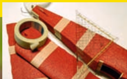
♥ Acryllack von Marabu haftet sehr gut auf EPP - vorher wird mit Tesa-Krepp abgeklebt
