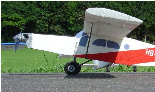
Die im Bausatz zu kurzen Flächenstreben habe ich durch dünnwandiges 6mm-Aluminiumrohr ersetzt, was der Gesamtoptik ebenfalls sehr entgegenkommt. Da das Original nur je eine Strebe hat hab ich die geplante hintere gleich weggelassen. Die damit eigentlich zu erreichende Schränkung der Fläche zur Herabsetzung der Stall-Geschwindigkeit wurde somit schlichtweg nicht umgesetzt.
