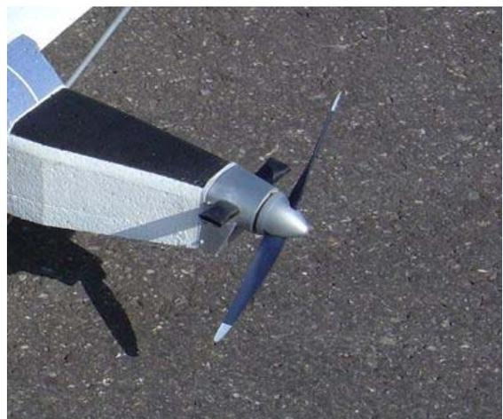
Zur Aufnahme des Antriebs wurde eine 6mm Sperrholz Platte in Form gebracht und eingearzt. Die ganze Konstruktion Aluhaube, Spannt mit Motor und Lüftungsblech kann mittels 8 Stück 1.5mm Spanplatten-Schlitzschrauben ganz einfach am ursprünglichen Spannt befestigt werden.
